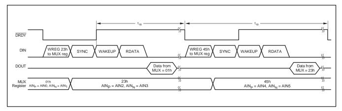
Figure 19. Cycling the ADS1256 Input Multiplexer
