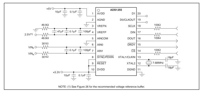
Figure 25. ADS1255 Basic Connections
